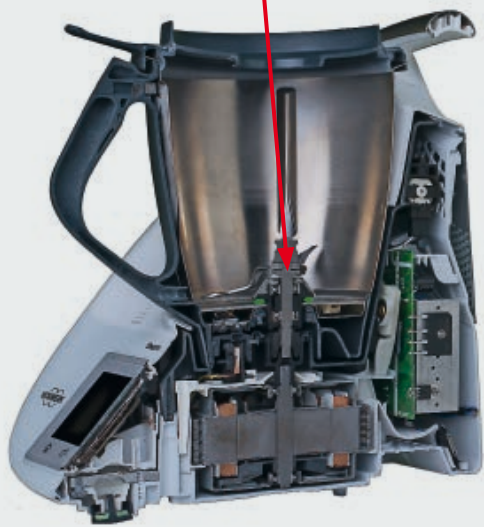
Der Thermomix im Schnitt: Vorwerk verbaut nur hochwertigste Komponenten. Die für die Lebensdauer und Handhabung entscheidenden Bauteile werden im Wuppertaler Stammwerk produziert. Das Mixmesser ist das Herzstück. Es bringt Drehmoment und Drehzahl an die Lebensmittel.
